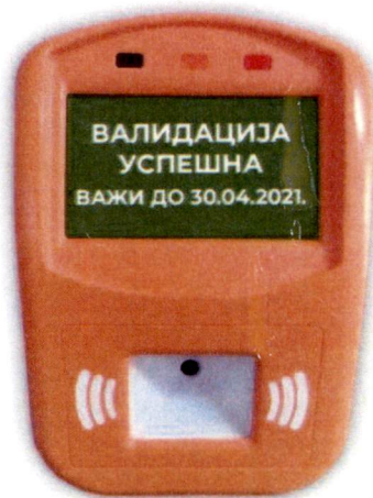
слика 10. Порука на валидатору у случају успешне валидације персонализоване картице
